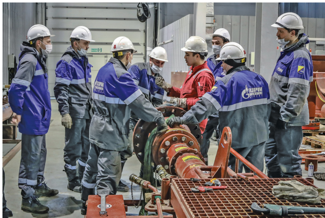
Идет оснастка машины ТМ-1200, задача – произвести врезку в трубу диаметром 377 мм (фото: Оксана Платоненко)
