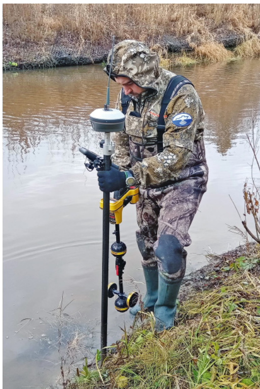
Топографическая съемка подводного перехода. В руках специалиста – антенны диагностических приборов
