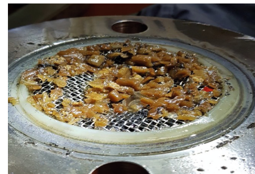
Вот такими полимеризованными частицами масла и забиваются фильтры агрегатов
