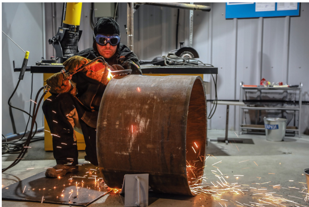
Отверстие в стенке трубы вырезано, начинается кропотливая обработка поверхностей
