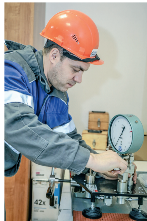
Метрологическое обследование на КС-5: слесарь КИПиА Алексей Орлов проводит калибровку манометра
