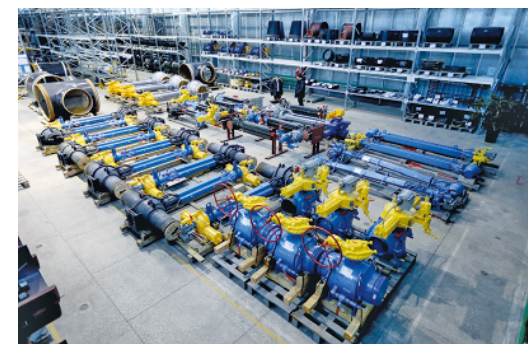
Шаровые краны, тройники, заглушки. Все это нужно для ремонта газопровода
