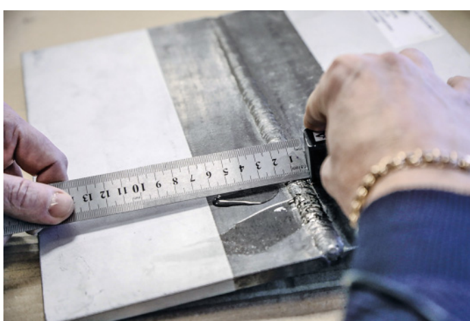
Измерение координат выявленных дефектов – чистая математика
