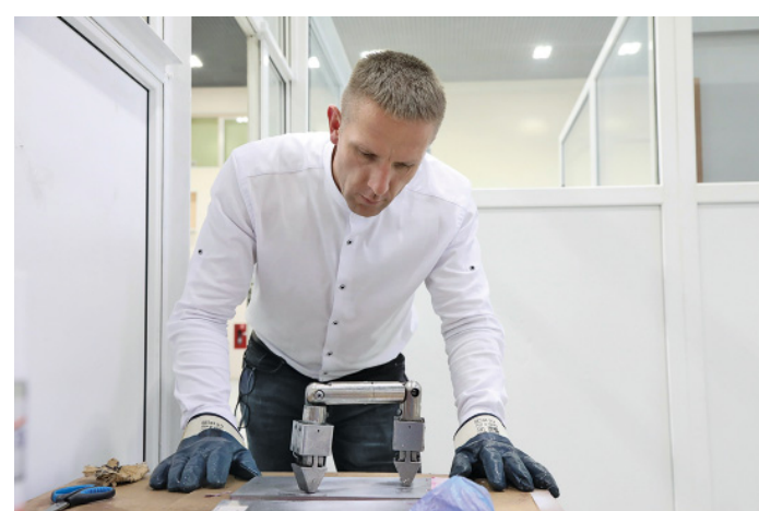
Так выглядит процедура магнитопорошкового контроля
