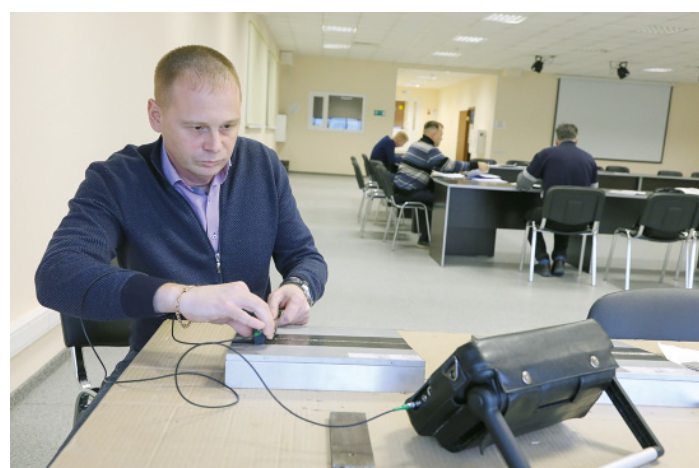
Ультразвуковой контроль образца сварного соединения
