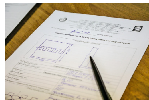
Техкарта ультразвукового контроля сварных соединений стальных пластин
