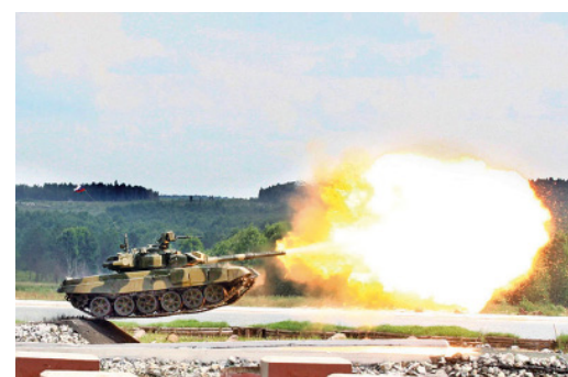
После сборки каждый танк проходит испытания на специальном полигоне, где проверяют его ездовые качества, пристреливают орудие и пулеметы
