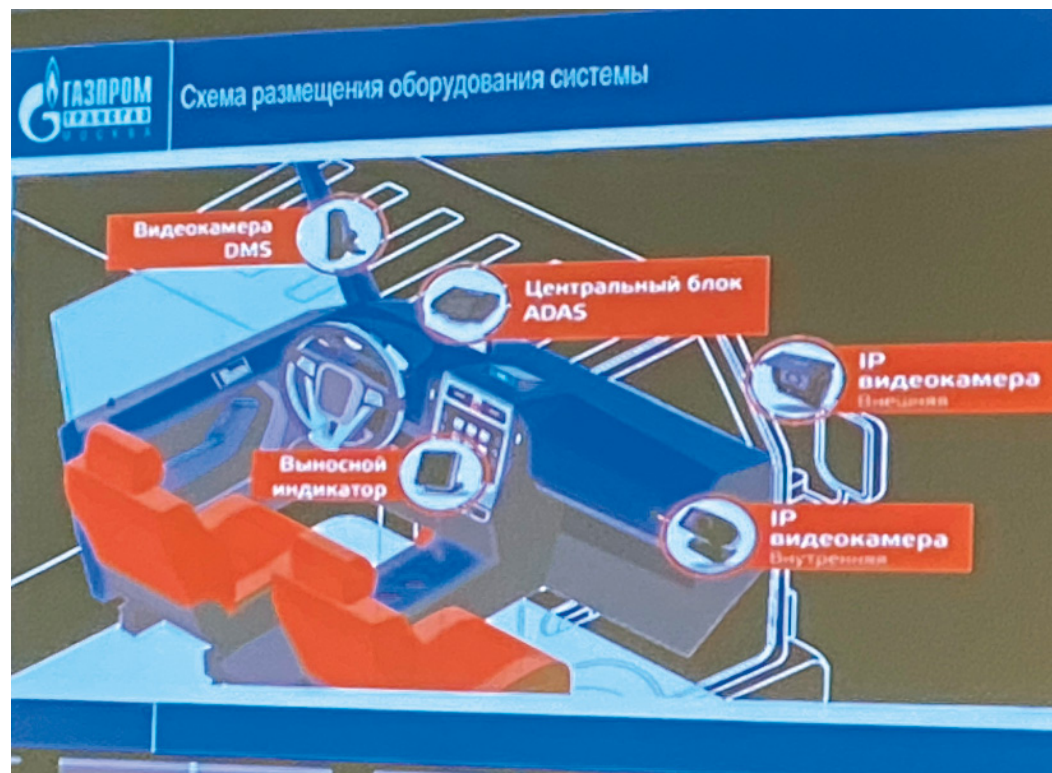
Комплекс интегрированных в единую IT-систему видеочкамер призван вести контроль за физическим состоянием водителя
