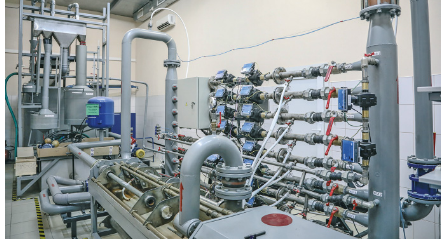
Проливная установка «Спрут» позволяет проводить калибровку в полностью автоматическом режиме
