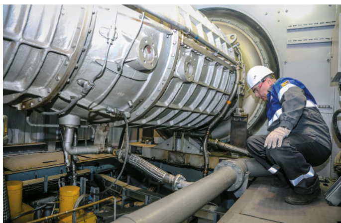
Сердце ГПА-10-01 – судового газотурбинный двигатель
