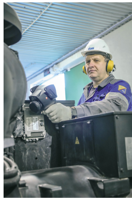
Тепловизионный контроль равномерности нагрева цилиндров – один из важных этапов диагностики АДЭС
