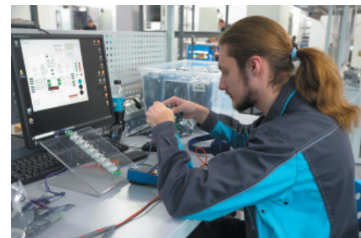
В этом цеху специалисты НПФ проводят тестирование программно-технических средств автоматизации
