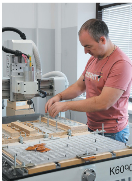
Подготовка корпусов к сборке включает в себя фрезеровку на специальном станке
