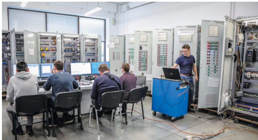
Здесь производятся испытания готовых систем управления, при которых обязательно присутствуют представители заказчиков
