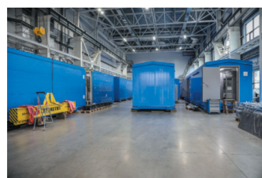
Цех сборки комплексных систем управления – собранные шкафы здесь помещают в огромные контейнеры
