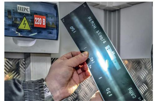
Каждый сварной шов снимают на пленку и проверяют на месте работ
