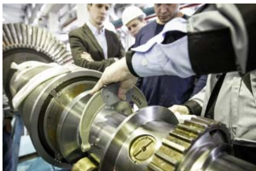
При замере шеек подшипника нужна предельная внимательность
