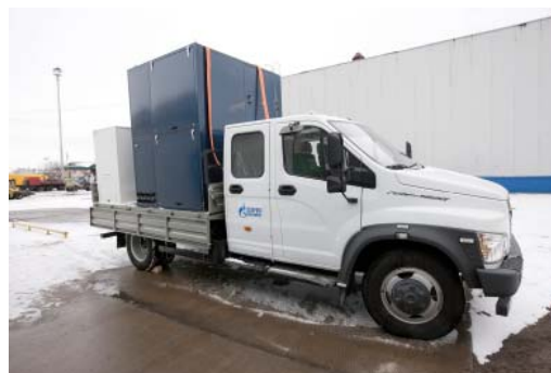
Нагрузочная установка готовится к испытаниям
