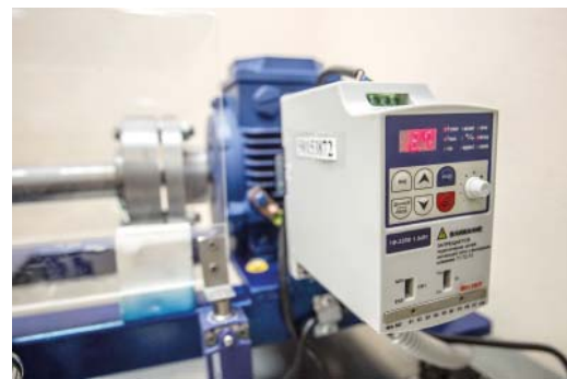
Частотный преобразователь, служащий для изменения оборотов вращения вала стенда
