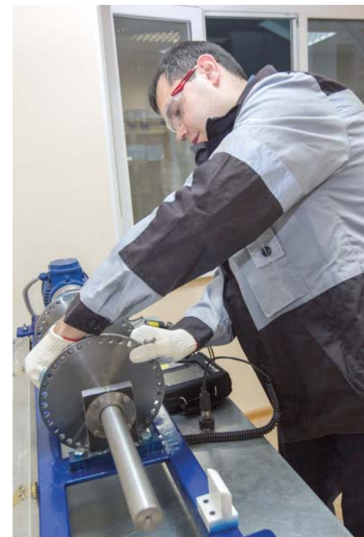
Процесс перестановки разборных балансировочных плоскостей
