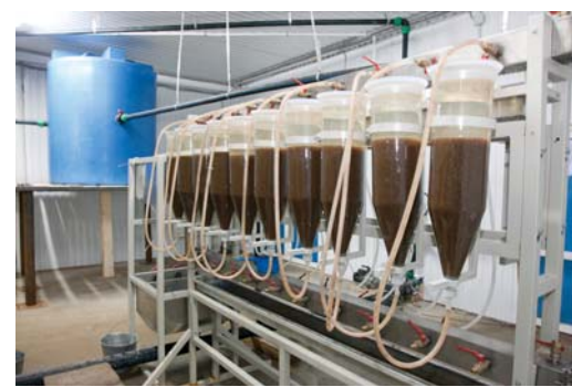
В таких колбах имитируется жизнь настоящей реки с подводными течениями
