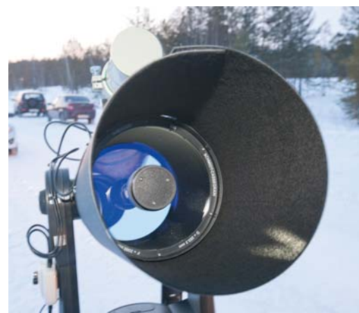
Сердце телескопа – главное зеркало. Здесь его диаметр – 203,2 мм
