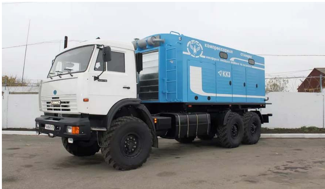
Предназначение МКС – удаление остатков метана из магистрали
