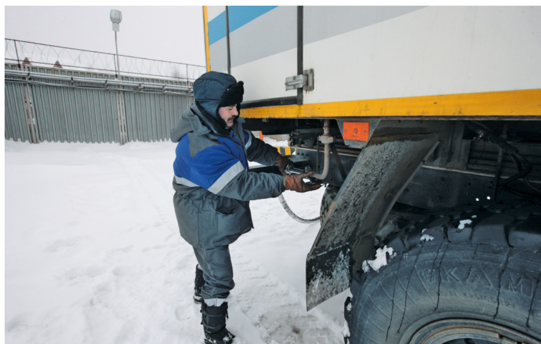
При высоком давлении машинист подключает металлическую трубу, при низком – достаточно и шланга
