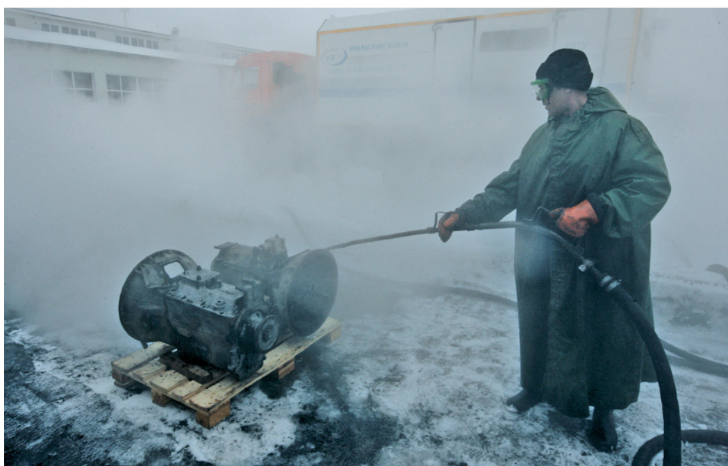
Качественно очистить карбоку передач автомобиля от масла и накипи можно только при помощи ППУ
