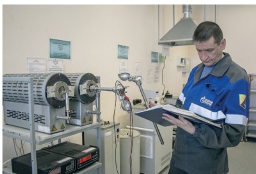
Слесарь КИПиА Андрей Филатов выполняет калибровку термомреобразователей
