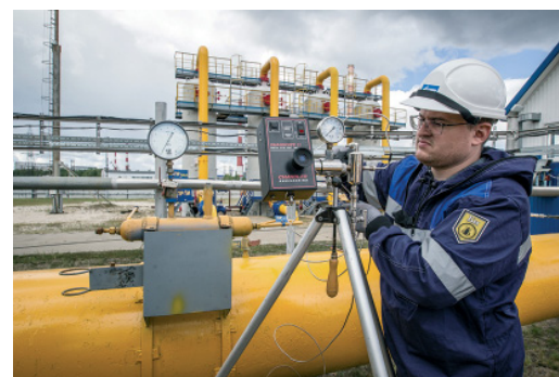
Инженер центральной химико-экологической лаборатории Андрей Белоглазов измеряет температуру точки росы
