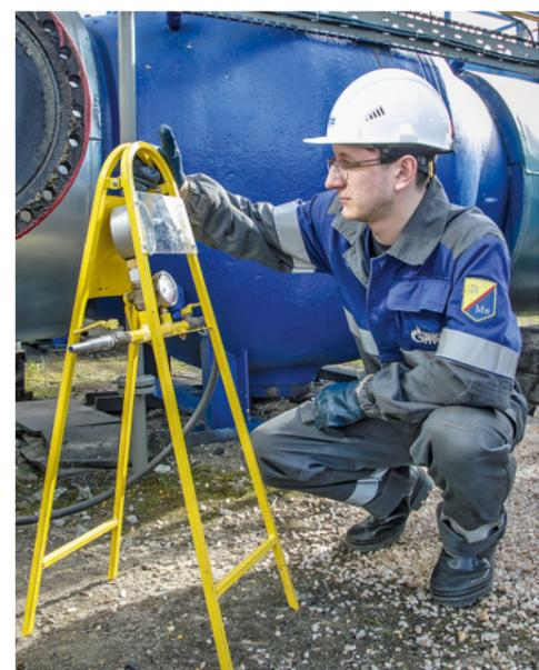
Диагностика позволяет определить сроки безопасной эксплуатации кранов и задвижек
