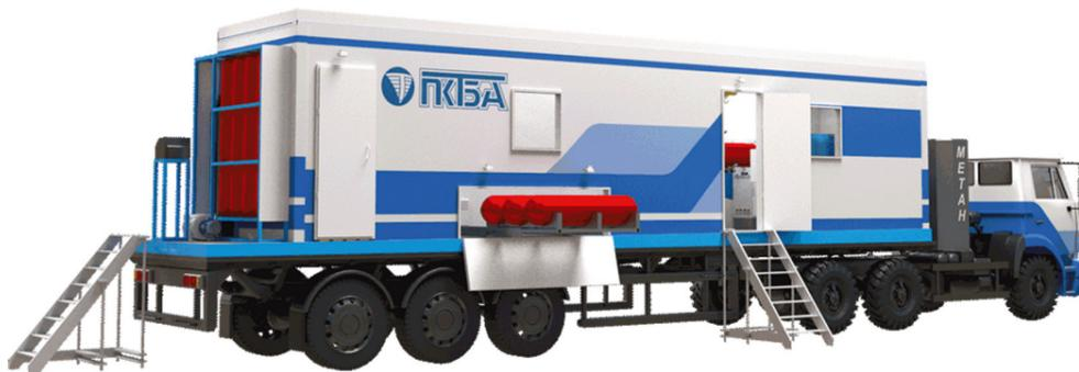
Мобильный комплекс для освидетельствования баллонов выполнен на базе полуприцепа
