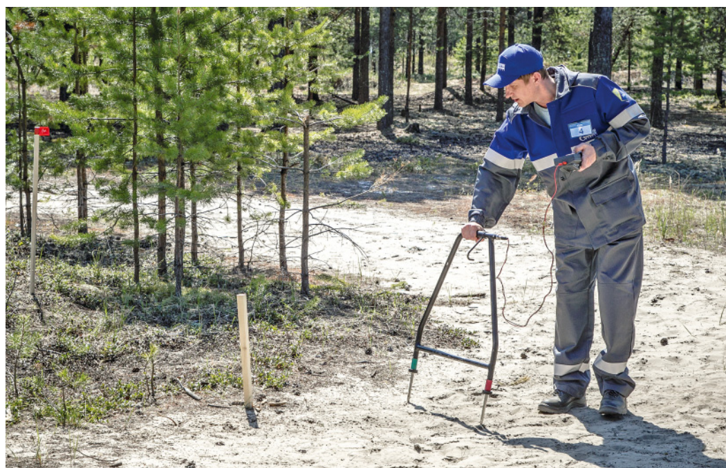
При помощи прибора УТ-1 «Менделеевец» участник конкурса выявляет повреждение изоляции
