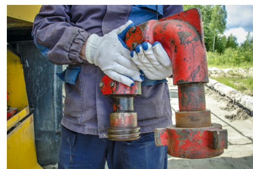
Такими 15-килограммовыми «подковами» подключают шлейф с водой
