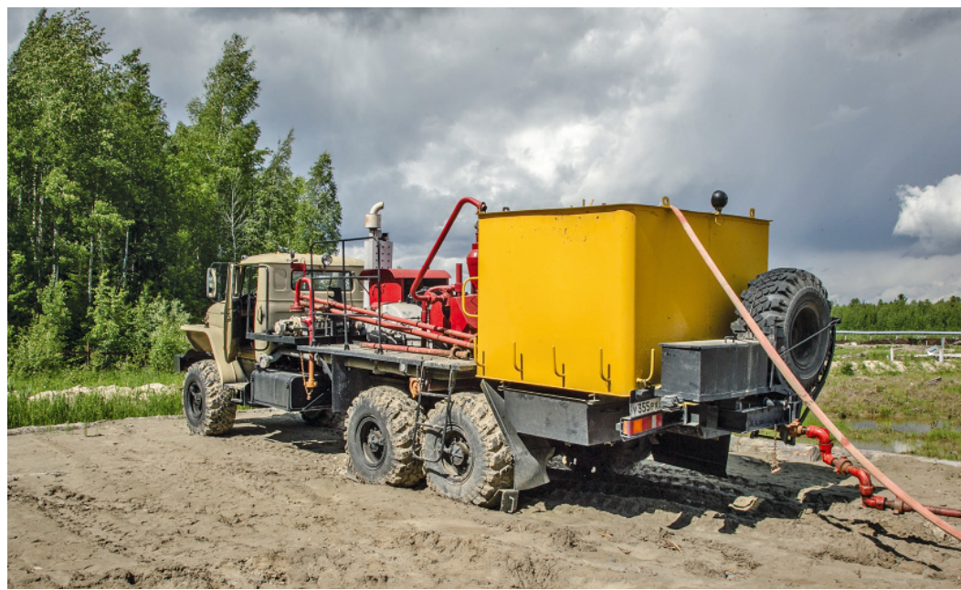
Компрессорная установка АЦ-320 должна располагаться не ближе двухсот метров от места испытаний
