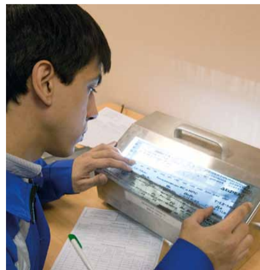
Дефекты пока просматривают на пленке
