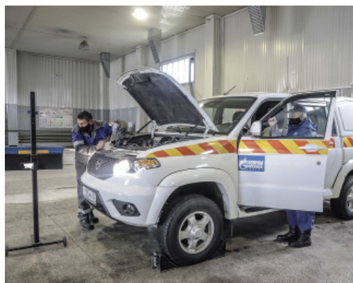
Автослесарь Алексей Прошин (Тюменский АВП) регулирует фары автомашины на стенде
