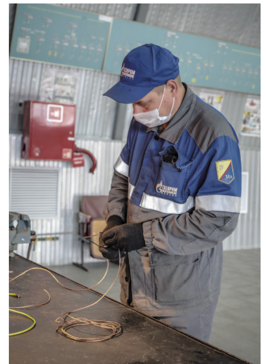
Электромонтер Дмитрий Нехай (Ишимское ЛПУ) ремонтирует заземляющий проводник
