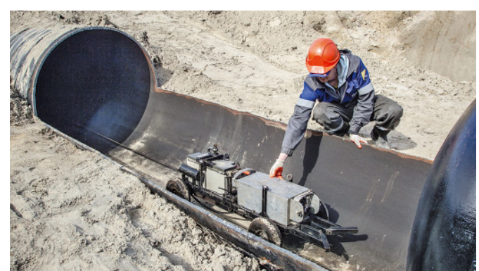
Там, где не проходит обычный поршень-дефектоскоп, можно использовать работу на дистанционном управлении
