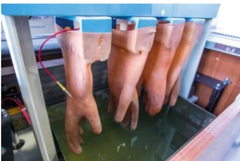
К погружению готовы. Испытания диэлектрических СИЗ должны проводиться в водной среде
