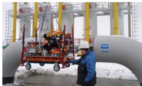
На базе Первомайской КС ООО «Газпром трансгаз Москва» впервые в рамках ПАО «Газпром» создан учебный полигон – натуральный стенд для испытаний оборудования внутритрубной диагностики компрессорных станций. Объектом диагностики, в зависимости от решаемых задач, могут являться технологические коммуникации целого компрессорного цеха – от подключающих шлейфов до внутритрубных трубопроводов, включая обвязки ЦБН.
