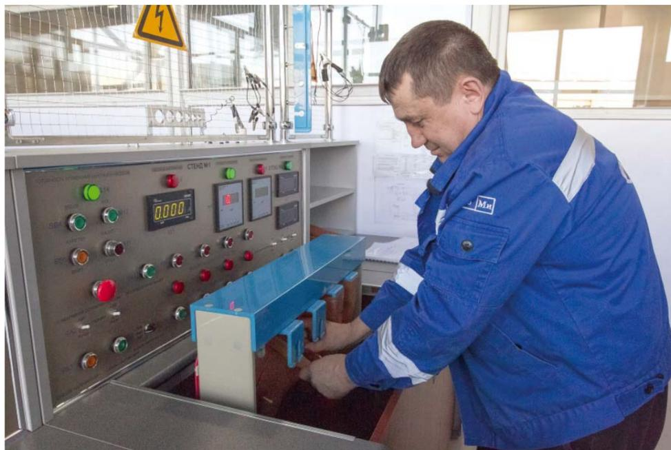
Перчатки надеваются на специальные раструбы пальцами вниз, затем автоматически наполняются водой. Испытания проводит электромонтер Сергей Вергейчик (фото: Оксана Платоненко)
