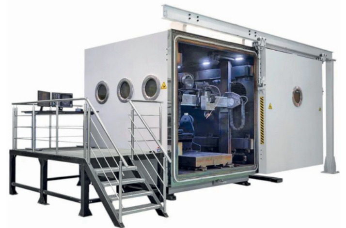
Одна из разработок Росатома – электронно-лучевая установка наплавки проволоки (ЭЛУНП). Электронный луч плавит проволоку в вакууме и «выращивает» металлическую деталь послойно (Фото с сайта «Росатом – Аддитивные технологии»)
