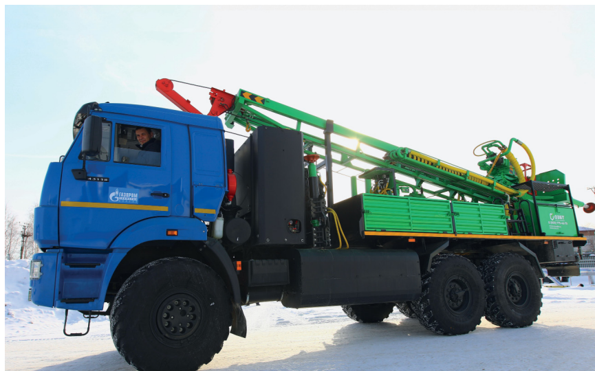
Установка способна бурить до 350 метров в глубину (фото: Юрий Меремкулов)
