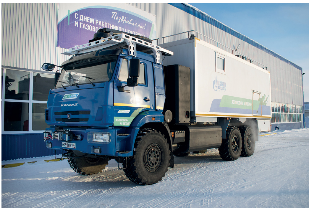
«Офис на колесах» установлен на шасси внедорожного КамАЗа
