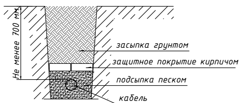
Схема укладки кабеля в траншею
